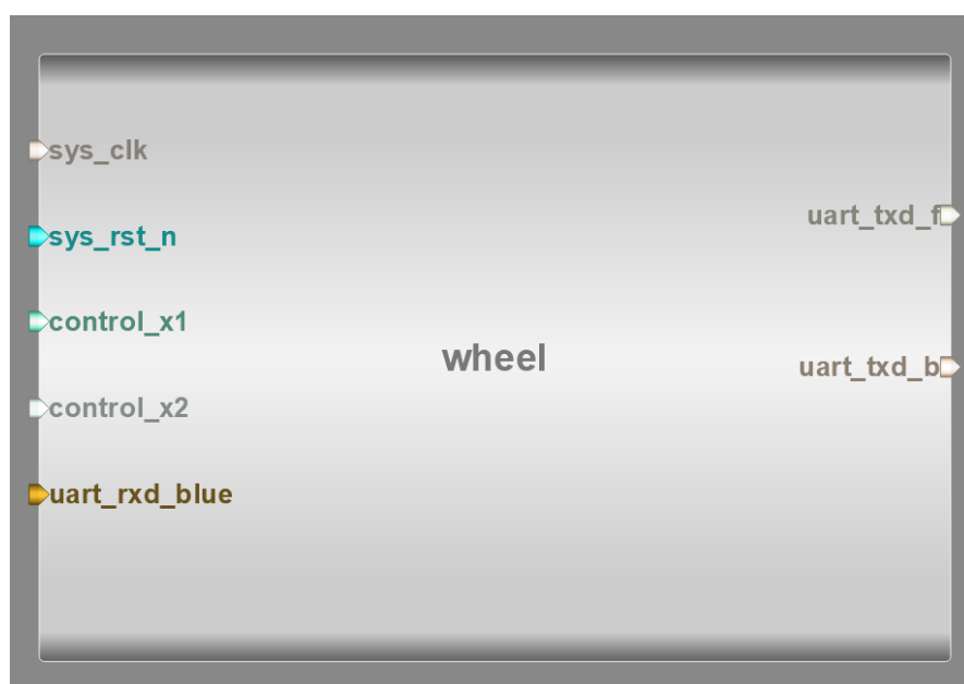
图3.1.1麦克纳姆轮直接驱动模块
